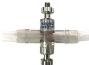
Accoppiatori ottici installati sulla cella a flusso
