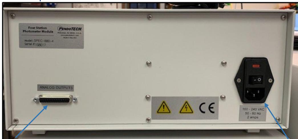
Connettore DB25 per uscite analogiche
