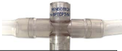
Cellule à circulation avec les tubes installés
